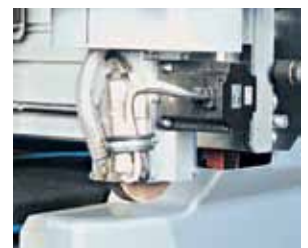
Mola periferica per la rimozione del basso emissivo ad alta velocità Peripheral wheel for high speed low-e removal
