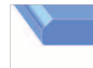
Filo piatto con profilo a 45° Flat edge with 45° bevel
