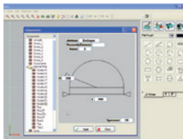
Libreria di figure parametriche o importazione di file .dxf Parametric shapes library or .dxf files import
