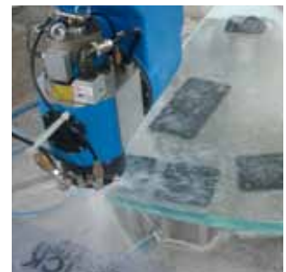
Lavorazione vetro blindato e di sicurezza Bullet-proof and safety glass processing
