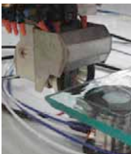
Filo piatto con rinvio Flat edge with cup wheel and angular gear
