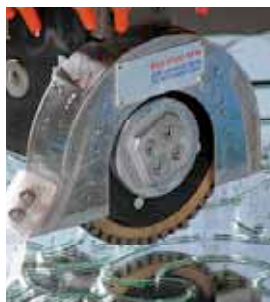
Incisione con rinvio Engraving with angular gear
