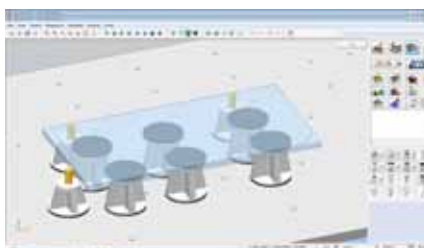
Posizionamento di ventose e fermi di riferimento Suction cups and reference stops positioning
