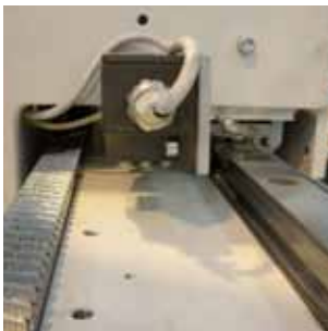
Assi lineari con movimento cremagliera/pignone Linear axes with rack and pinion movement
