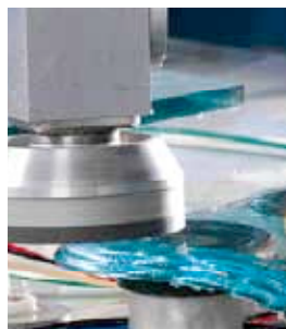
Bisellatura con rinvio Beveling with angular gear
